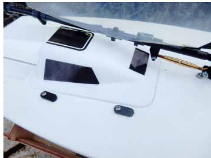
Die Luke ist absolut dicht, der Baumniederholer sollte allerdings noch eine Kontermutter erhalten
