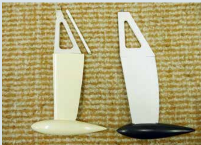
Rechts der neue Kiel mit deutlich nach hinten gepfeilter Flosse und weiter hinten liegendem Ballast, wodurch der Bug freier wird
