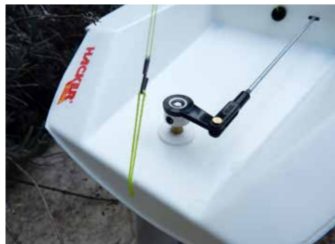
Die direkte Ruderanlenkung ist absolut spielfrei und robust
