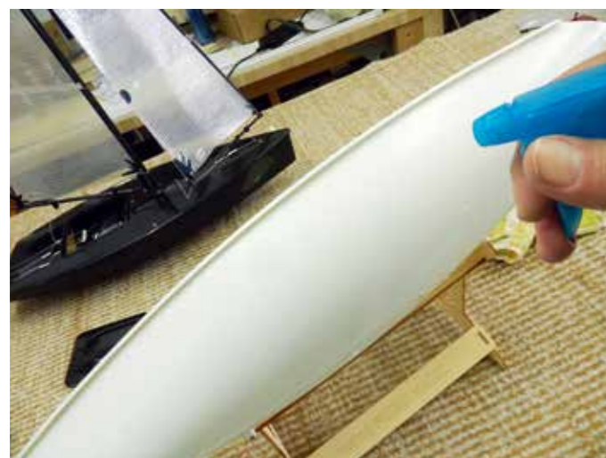
Spüliwasser erleichtert das Aufbringen der großflächigen Aufkleber ...
