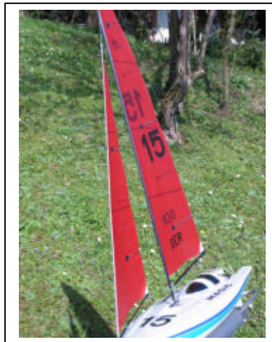
Bilder: Achterliekspannung / -rundung beim Vorsegel: Trimmung durch Dirk
