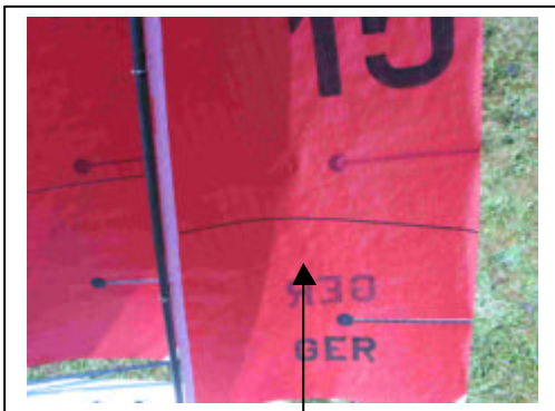
Kaum Spannung = max. Profiltiefe geht gegen Segelmitte
