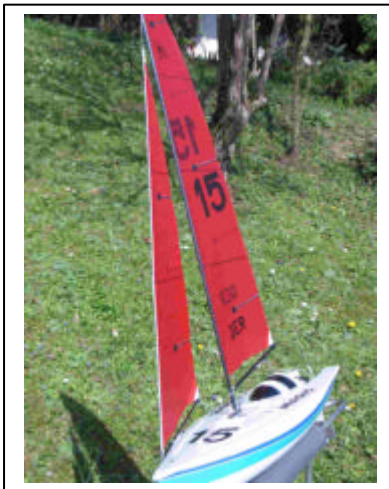
Bilder: Achterliekspannung / -rundung beim Vorsegel: Trimmung durch Dirk
