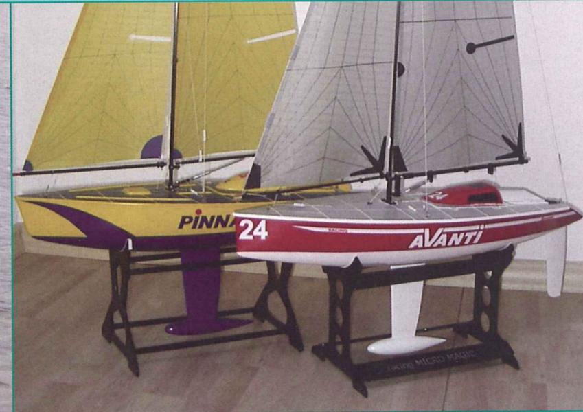
Die racing MM im Vergleich zu einer getunten Standard-MM. Deutlich ist der steilere Steven erkennbar
