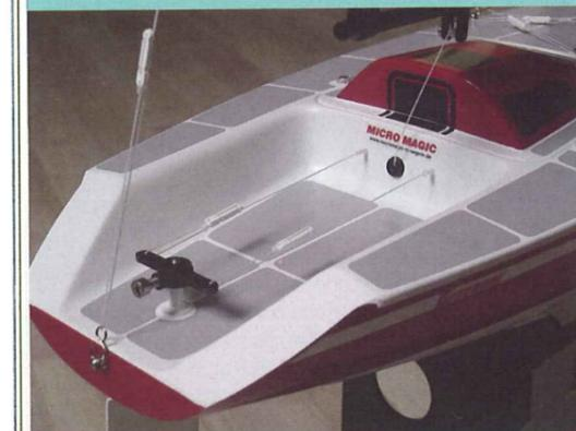
Heckansicht, gut erkennbar die Anlenkseile für das Ruder
