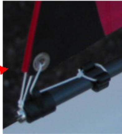
Fockbaum um 5 mm verlängern, z.B. mit einer Hülse
