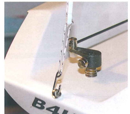
Ruderdruckfeder gegen Ruderspalt am Rumpf
