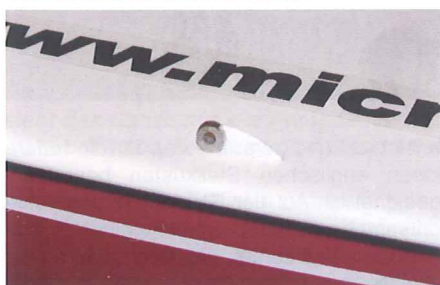
Verhackschutz an Decksösen
