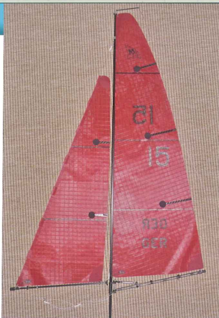
Reduziertes A-Rigg mit breiten Segeltopps (Autor)
