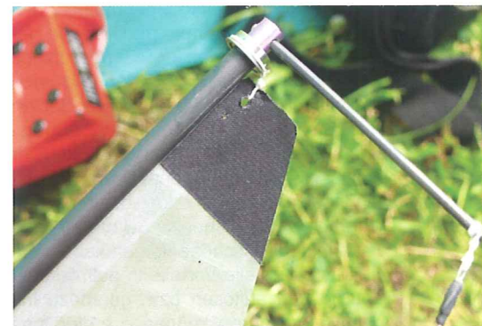
Einfachste Version eines kugelgelagerten Großsegelkopfs (Autor)
