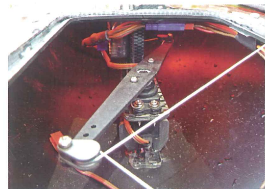
ce-rMM mit Foliendeck und minimalistischem RC-Einbau (Hansjörg Hörsch)
