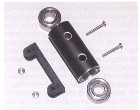
Großbaumbeschlag im Eigenbau (Autor)
