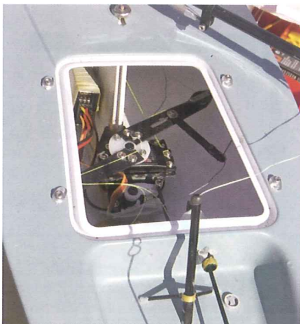
Asymmetrischer Schotverstellarm am Boot von Henning Dresel
