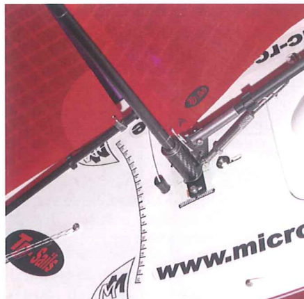
Rigg mit axialem Großbaumbeschlag, Deck mit Trimmsskalen (Autor)
