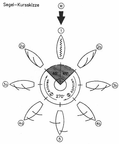
Boot mit dem Heck immer mehr in Windrichtung drehen(II)/Anluven: Boot mit dem Bug immer mehr in Windrichtung drehen(I)) gelangt es auf den raumen Kurs, bei dem die Segel auf ca. 60° zur Bootsmitte gefiert werden (4a/4b). Nur auf diesen beiden Kursen kann die max. Bootsgeschwindigkeit erreicht werden.
