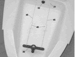
Seildurchführungen (Pos. 31), längen diese aus dem Bowdenzuginnenrohr auf 15mm ab und kleben diese mit Sekundenkleber in den Rumpf. WICHTIG: Achten Sie bei dieser Arbeit darauf, dass die späteren Zugseile möglichst gerade laufen.
