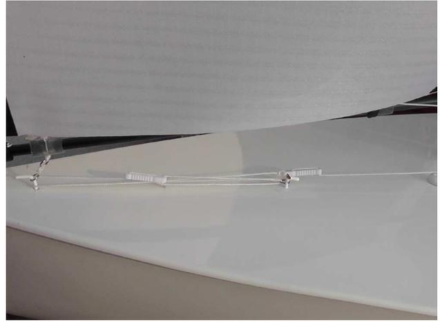
A l'extrémité arrière du bôme de foc le balancin a déjà frappé. Il permet à la torsion de la voile d'est réglé plus tard. Exécutez l'extrémité libre du balancin vers le haut à travers l'anneau sur le mât, l'inventeur bloque l'étai et l'attache serré. Tirez sur la languette de la borne sur le balancin légèrement vers le haut de telle sorte que la chute de la voile d'avant décrit une légère courbe.
